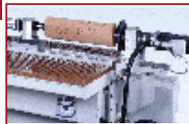
Bloccaggio punta-contropunta con rotazione di 360° da CN Stock tail locking system with 360° rotation controlled by NC Устройство блокировки деталей с вращением 360° управляемое ЧПУ
