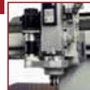
Testa "tour" per rotazione rinvio di 360° da CN "Tour" head for aggregate with 360° rotation by NC Агрегат "TOUR" с вращением 360° управляемый ЧПУ
