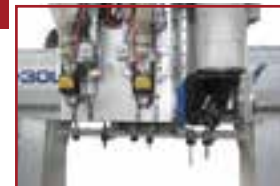
2 motori verticali e 1 motore tipo TWIST Two vertical motors and one motor 5 axis два вертикальных двигателей и один тип двигателя пять осей
