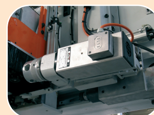
■ MOTOR CON PALPADOR POR LOS PERNIOS FLOATING HEAD FOR THE HINGES
